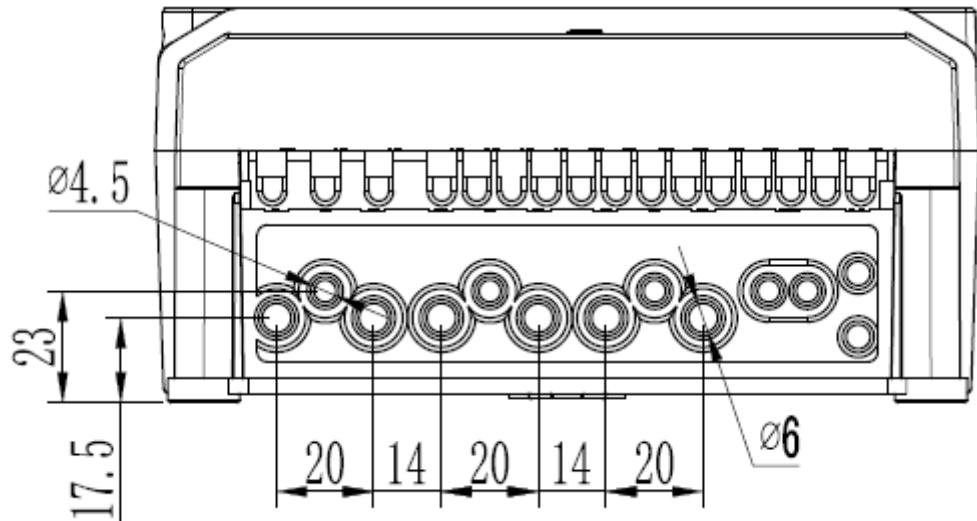
Рисунок 4-3 Клемний блок лічильника4
