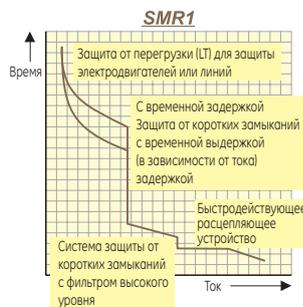
Расцепитель обеспечивает защиту от перегрузки (LT) и коротких замыканий (ST). Устройство защиты от перегрузки позволяет регулировать настройки в диапазоне 0,4–1 x выбранный номинальный ток и имеет две зоны защиты (LTD): одна для защиты линий, а другая для защиты электродвигателей (класс 10)<sup>(1)</sup>. Для обеспечения
