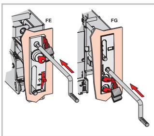
Накладная пластина выполняет функции панели управления и индикаторной панели и включает следующие элементы: – Прорезь для рукоятки. Вращая рукоятку против часовой стрелки или по часовой стрелке, можно, соответственно, извлечь или установить на место выключатель.
