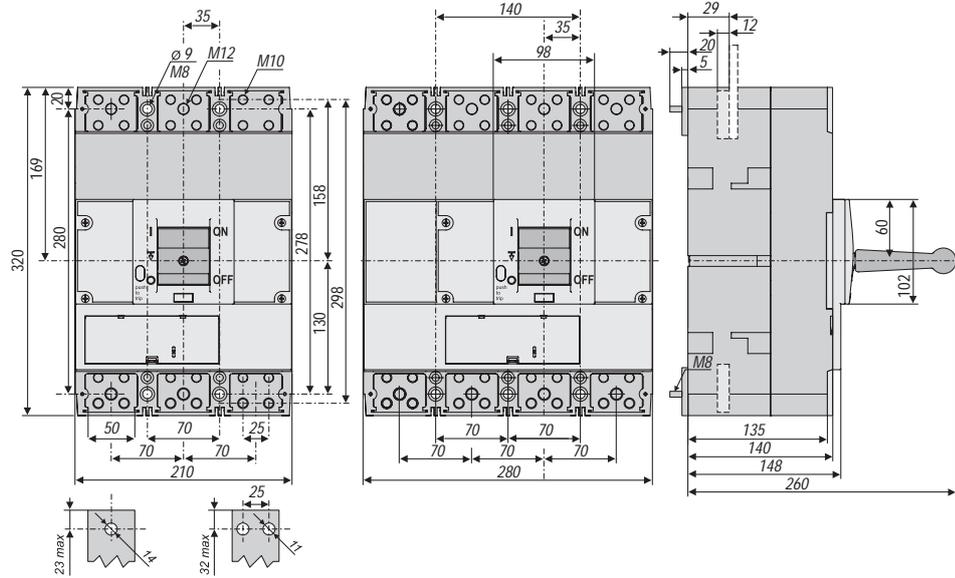
Выключатель с электрическим оператором – рамы FK800/1250/1600
