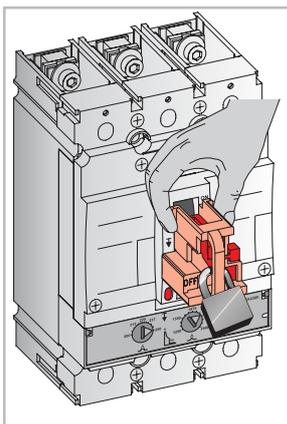
Съемные блокировочные устройства **Record Plus™** надежно крепятся к выключателю, только когда последний требуется заблокировать. Если же выключатель не применяется, блокировочное устройство можно снять и использовать на другом выключателе. В этом устройстве может использоваться до 3 навесных замков с размером дужки от 5 до 8мм. Устройство поставляется в трех различных исполнениях: одно – для монтажных рам
