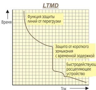
Этот расцепитель обеспечивает защиту от перегрузки и коротких замыканий. Настройки функции защиты от перегрузки можно изменять в диапазоне 0,8–1-кратного значения выбранного номинального тока, в то время как ток функции защиты от коротких замыканий установлен равным 10-кратному выбранному
