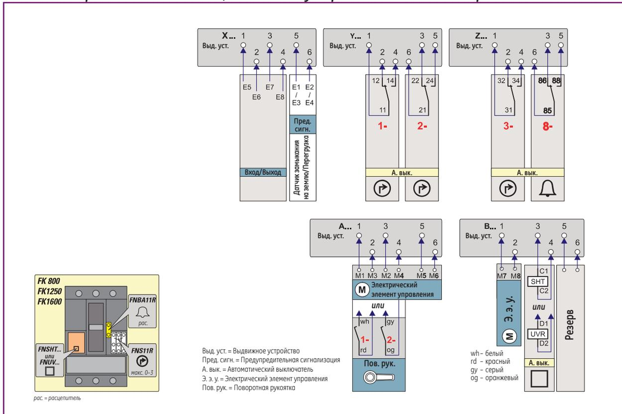
Монтажная рама FG, соединения с расцепителем SMR 2
