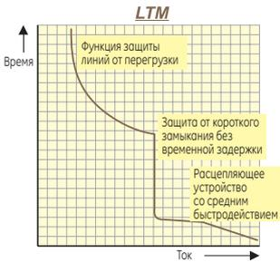
Этот расцепитель обеспечивает защиту от перегрузки и коротких замыканий. Настройки функции защиты от перегрузки можно изменять в диапазоне 0,8–1-кратного значения выбранного номинального тока, в то время как ток функции защиты от коротких замыканий установлен равным 10-кратному выбранному номинальному значению
