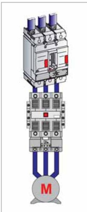
Защита от короткого замыкания и перегрузки с помощью электромагнитного автоматического выключателя в литом корпусе.
