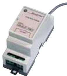
Данное внешнее устройство с модульными размерами, установленное на направляющей DIN, подключается непосредственно к электронному расцепителю типа SMR1. Устройство оснащено нормально замкнутым контактом на 1A/400В переменного тока, который размыкается при подаче сигнала, сигнализирующего о том, что расцепитель SMR1 в скором времени выполнит отключение
