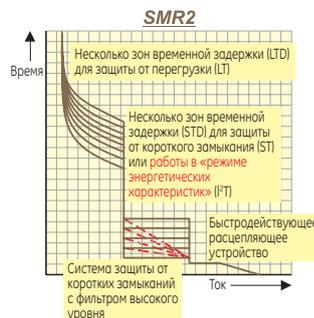
Расцепитель обеспечивает защиту от перегрузки (LT) и коротких замыканий (ST). Устройство защиты от перегрузки позволяет регулировать настройки в диапазоне 0,4–1 крат от выбранного номинального тока и имеет несколько зон защиты (LTD). Устройство защиты от короткого замыкания (ST) позволяет регулировать настройки
