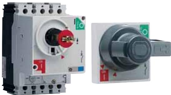
В данном случае рукоятка и накладная пластина устанавливаются с лицевой стороны дверцы или панели и соединяются с автоматическим выключателем удлинительным валом, который вставляется в переходный блок, монтируемый непосредственно на передней части выключателя. Общая глубина (от тыльной поверхности автоматического выключателя, установленного за дверцей или панелью, до лицевой поверхности дверцы или панели) такой конструкции может достигать 350мм.
