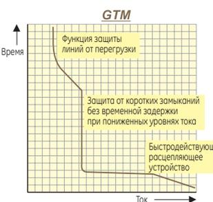
Этот расцепитель обеспечивает защиту от перегрузки и коротких замыканий. Настройки функции защиты от перегрузки можно изменять в диапазоне 0,8–1-кратного значения выбранного номинального тока, в то время как ток функции защиты от коротких замыканий установлен равным 4-кратному выбранному
