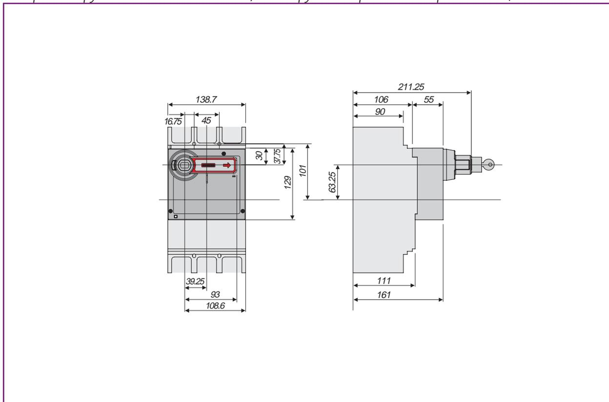
Поворотная рукоятка, монтируется на дверце – рамы FG400/630
