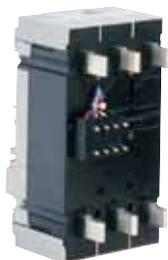
Подвижная часть, вставляемая в выключатель, включает в себя набор многополюсных вилок, который заменяет стандартное соединение с передним доступом. Она также включает устройство блокировки расцепления, которое, когда установлено, расцепляет выключатель во время его извлечения с основания и предотвращает его установку на основание во включенном состоянии. Подвижная часть поставляется вместе с короткими щитками для клемм, которые предотвращают несанкционированное использование.
