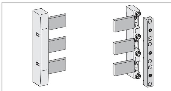
В качестве стандартных опор для шин поставляются опоры, подготовленные для размещения шин сечением 30 x 5мм. Однако эти опоры могут быть легко приспособлены для любого другого размера, указанного на встроенном разделительном элементе.
