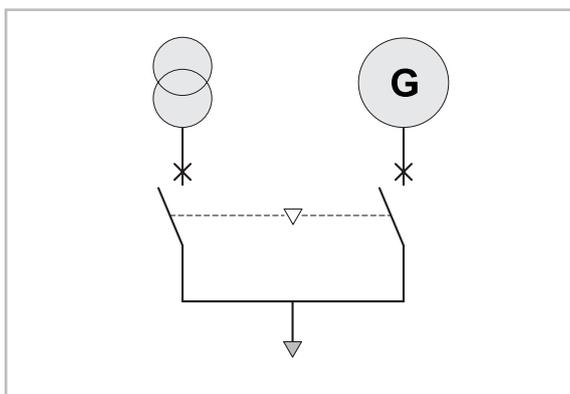
В связи с различными требованиями к сетям электропитания системы изначально рассчитаны на работу от двух или трех источников питания<sup>[1]</sup>. Передача электроэнергии между трансформатором и генераторным агрегатом (или двумя трансформаторами) осуществляется через систему, состоящую из двух выключателей.
