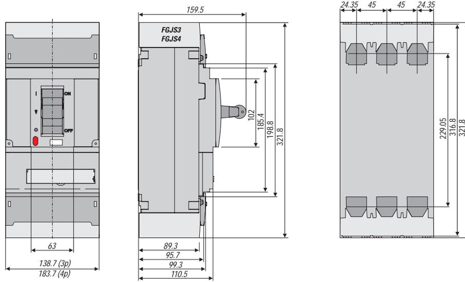
Выключатель со средними щитками для клемм – рамы FG400/630
