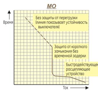
Этот расцепитель обеспечивает защиту только от коротких замыканий. Он позволяет осуществлять регулировку в диапазоне 10–15 x выбранный номинальный ток. Для предотвращения перегрева устройства защиты (автоматического выключателя) требуется ограничить ток в защищаемой им цепи (см. пунктирную линию).
