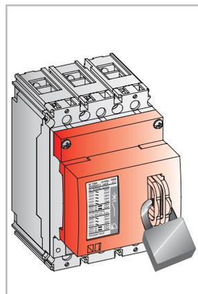
Навесное блокировочное устройство, которое крепится винтами к передней части выключателя и обычно остается на выключателе. Это устройство обеспечивает блокировку выключателя в отключенном положении с помощью навесных замков количеством до трех штук и размером от 5 до 8мм. Замок также блокирует рукоятку переключения расцепителя. Устройство поставляется в трех различных вариантах
