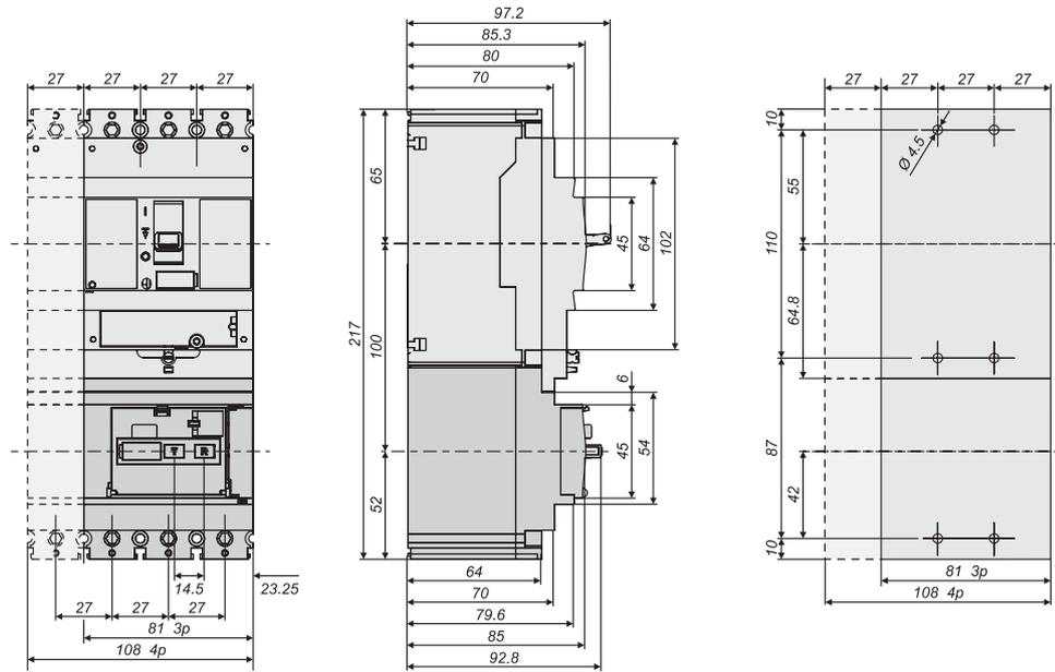
Устройство контроля за остаточными токами (RCD), монтируемое снизу - FE160 и FE250
