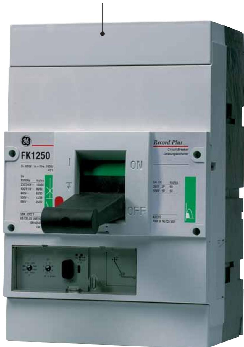
Автоматические выключатели **Record Plus™** предназначены для защиты, изоляции и коммутации цепей в низковольтных распределительных сетях. Защита цепей обеспечивается путем применения комбинации приборов с уникальными токоограничительными свойствами и встроенных защитных устройств, которые обычно называются расцепителями.
