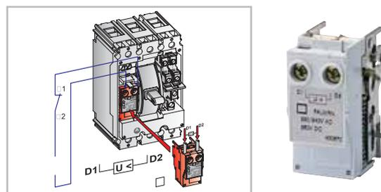
Если автоматический выключатель включен (ON) и расцепитель минимального напряжения деактивирован, выключатель сработает, в результате чего его контакты разомкнутся. В обесточенном состоянии устройство предотвращает перемещение контактов выключателя и может применяться в качестве блокировочной катушки. Соединительные зажимы имеют маркировку D1 и D2. Обесточивание устройства или падение напряжения его питания до величины ниже указанного предела приведет к срабатыванию устройства.
