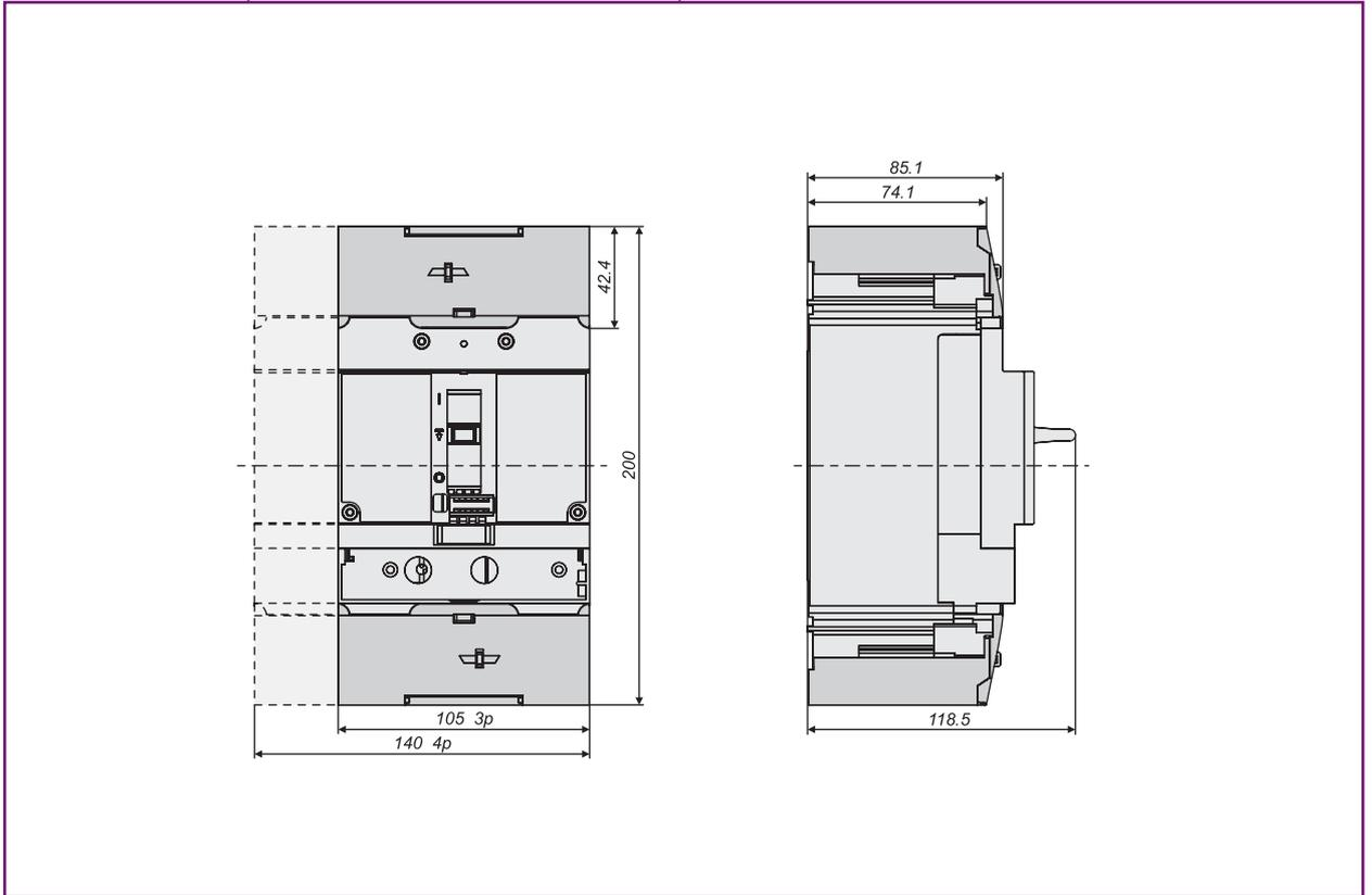
Выключатель с длинными щитками для клемм – рамы FE160 и FE250
