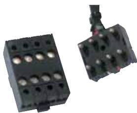
В состав комплекта входят вилка, прикрепленная винтами к задней стенке выключателя (подвижная часть), и розетка, которая вставляется со щелчком во втычное основание (фиксированная часть). Розетка поставляется вместе с подсоединенными проводами, имеющими цвето-
