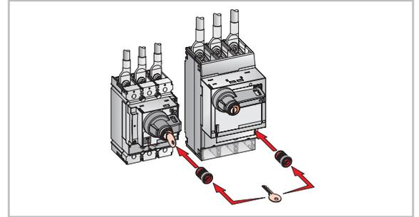
И блокировочный модуль, устанавливаемый за обоими устройствами. В данном случае выключатели установлены на специально предназначенные для этого переходные панели, которые обеспечивают сопряжение выключателя с блокировочным модулем.
