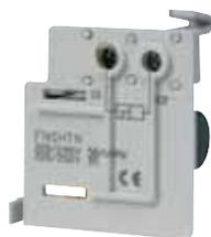
Если автоматический выключатель включен (ON) и независимый расцепитель активизирован, выключатель сработает, в результате чего его контакты разомкнутся. Устройство может быть постоянно активизировано, если на него подается номинальное напряжение, в этом случае его можно использовать как блокировочную катушку. Соединительные зажимы имеют маркировку C1 и C2. Для управления независимым расцепителем используются переключатели, релейные контактные группы и кнопки.
