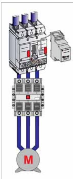
Защита от короткого замыкания и перегрузки с помощью электронного автоматического выключателя в литом корпусе.
